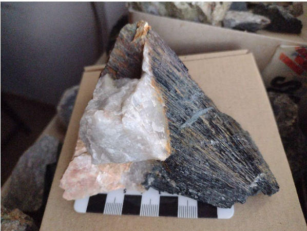
Turmalină în cuarț asociat cu feldspat potasic, Smolné Pece, districtul Karlovy Vary
